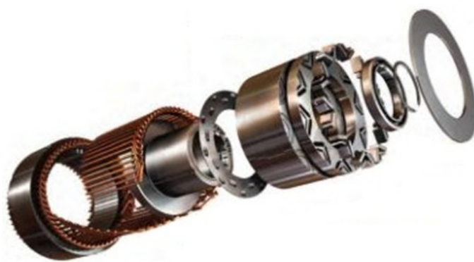
Figure 2 : Vue éclatée d'un moteur de véhicule électrique à aimants permanents.
